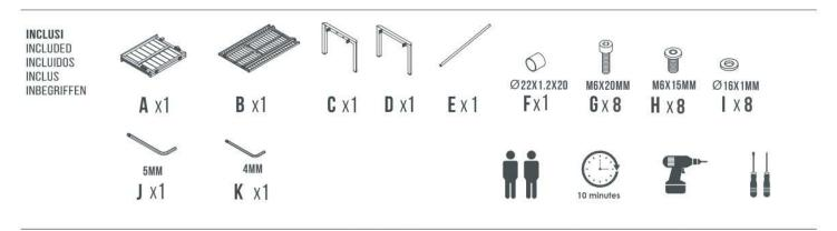
ANTES DEL MONTAJE, ASEGÚRESE DE COLOCAR EL PRODUCTO SOBRE UNA SUPERFICIE LIMPIA Y PLANA Y USE UNA TELA SUAVE COMO SOPORTE PARA EVITAR GOLPES Y daños al producto durante el montaje. No apriete los tornillos hasta que se encuentren en la posición correcta.
